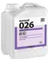
Verarbeitungsfertige, 1-komponentige Feuchtigkeitssperre auf Dispersionsbasis zum Absperren nicht drückender Restfeuchtigkeit bis 4 CM % von schwimmenden Zementestrichen. Keine Absandung bei nachfolgenden Spachtelarbeiten notwendig! Lange Überarbeitungszeit von 7 Tagen! Bei der Direktverlegung von Mehrschichtparkett mit Eurocol 154 Eurowood SF Ultra ist eine Restfeuchtigkeit von bis zu 3 CM % möglich.
