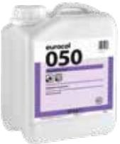
Mit Wasser verdünnbare Dispersionsgrundierung zur Vorbehandlung saugfähiger, zementärer Estriche vor Spachtel- und Klebarbeiten. Je nach Untergrund mit Wasser im Verhältnis 1 : 4 bis 1 : 5 zu verdünnen. Auch zur Reststaubbindung vor der Klebung von Textilbelägen mit Dispersionsklebstoffen und zur Zwischengrundierung bei mehrschichtigen Spachtelungen.
