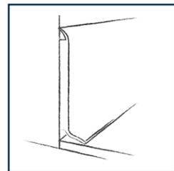
Halbstarre PVC-Sockelleiste für den dekorativen Einsatz mit oberer und unterer flexibler Kante.
