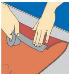
Halten Sie beim Zuschneiden des Belages zu Wänden, Einbauten und Mobiliar einen entsprechenden Abstand, damit der Vinylbelag bei Temperaturschwankungen Spielraum hat. Nun fixieren Sie den Rand- und Türbereich mit einem doppelseitigen, weichmacherbeständigen Klebeband. Vorhandene Luftblasen bitte ausreiben.
