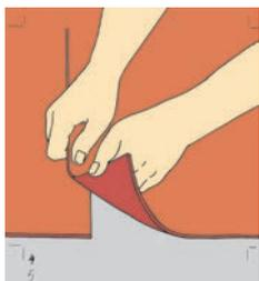
Prinzipiell ist eine Naht im Bereich der Produktionskante zu schneiden. Lassen Sie die Bahnenkanten überlappen und passen sofern notwendig den Musterrapport von der Mitte aus an. Fixieren Sie die Bahnen mit kurzen Klebebandstreifen, damit sie sich nicht verschieben können.
