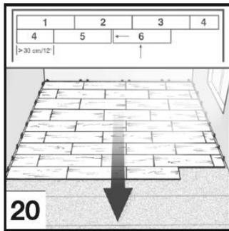
Zur Vermeidung von Kantenabsplitterungen sollte die Dekorseite bei der Nutzung von elektrischen Stich- oder Handkreissägen nach unten zeigen. Ansonsten von der Panoeloberseite her absägen. Jede neue Reihe mit dem Reststück (mindestens 30 cm Länge) der vorhergehenden Reihe beginnen.
