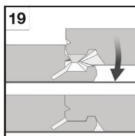
Ein zweites Paneel längsseitig in die Nutprofilierung der voran liegenden Paneele einlegen und in einem Winkel von 20° nach links bis zum bereits gelegten Paneel schieben. Anschließend nach unten hin abwinkeln und mit Druck von oben bis zum hörbaren Click einschnappen. Dabei ist darauf zu achten, dass das zu verlegende Paneel im Längsprofil sauber eingelegt und geführt wird.
