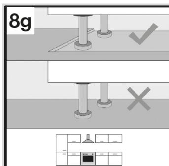
Einbauküchen und Einbauschränke müssen vor der Verlegung aufgebaut werden. Der Aufbau auf den Bodenbelag ist nicht zulässig.
