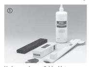
Verlegewerkzeug: Schlagklotz, Abstandskeile, Montageeisen, PVAC-Weißleim, Hammer, Bleistift, Säge.
